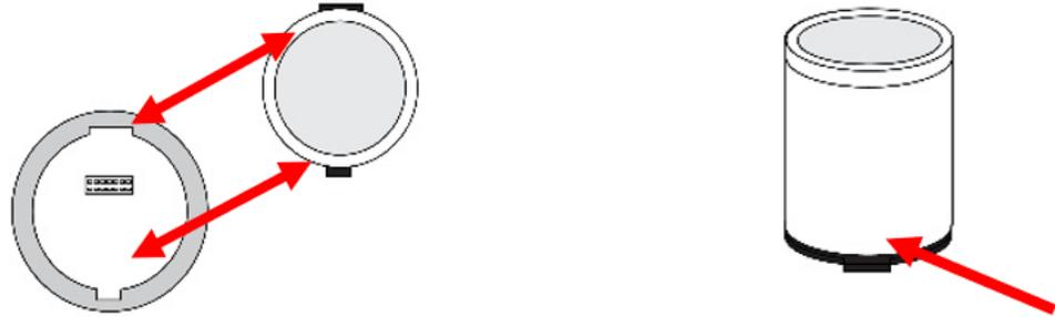
Combine as chaves de índice no módulo sensor com soquete Chave de indexação do sensor
