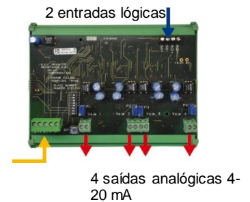
Figura 25: Princípio do módulo de 4 saídas analógicas.
