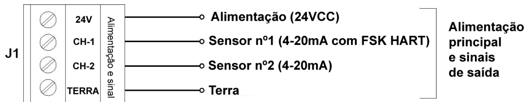
Figura A - -6 Conector J1 de energia e sinal no suporte HART iTRANS-2
